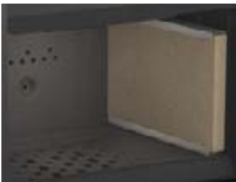
Foyer en fonte-vermiculite
